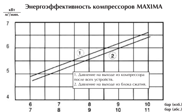
Рис. 12. У компрессоров «Маттей» падение давления после всех компонентов и устройств за блоком сжатия составляет всего 0,3—0,4 бара и для его компенсации требуется всего 3% потребляемой энергии.
